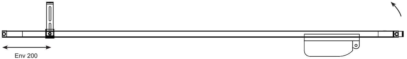
Le haut du rail doit être positionner à 150 mm du bas de la traverse linteau
