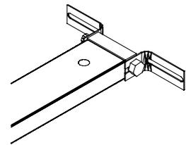
La patte d'extrémité fixe le rail en translation, il est donc important de bien la positionner. Utilisez la vis d'embout de rail du kit moteur
