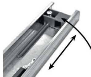
**! Serrer la vis de maintien sans forcer, au risque d'endommager le pas de vis.**
