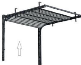
La porte doit manoeuvrer en ouverture, si ce n'est pas le cas, inversez les fils du bornier comme indiqué.
