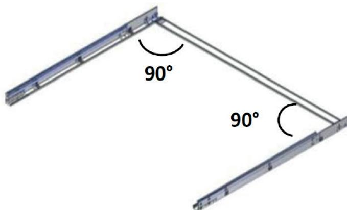
Assemblez les 2 montants verticaux et la traverse linteau.
